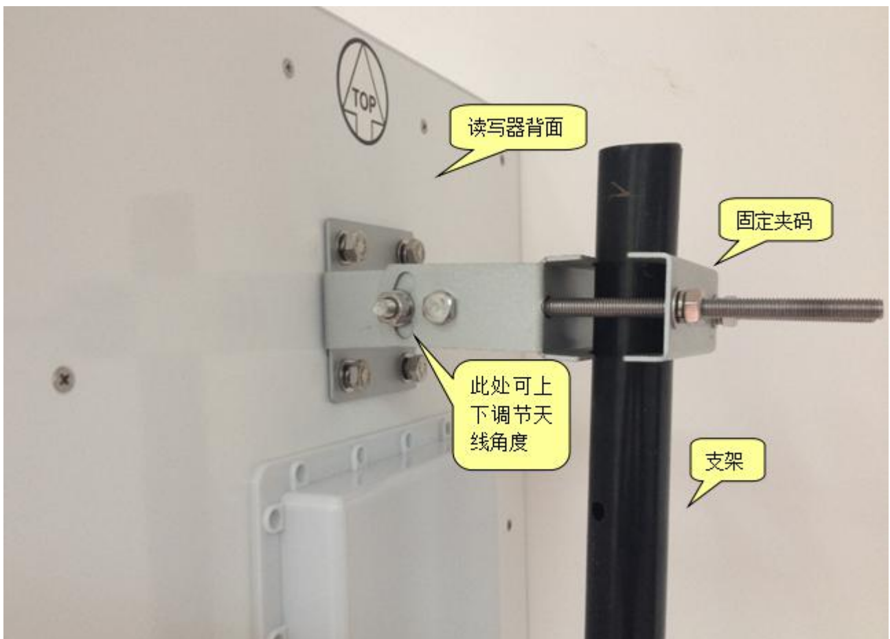
图 4 读写器安装图
