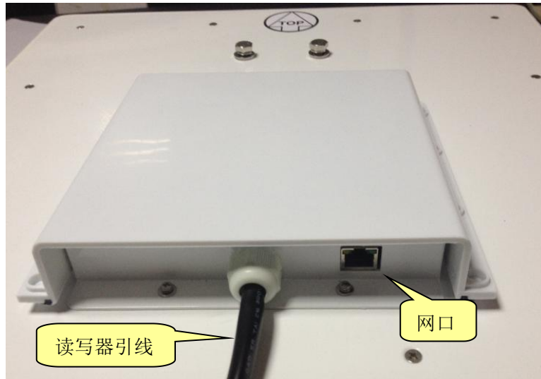
图 2 JT-9292 读写器网口示意图
